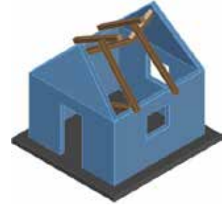
(i) kalkan duvar devrilmesi
